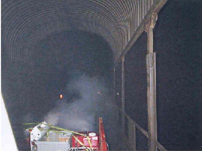
Abbildung 3: Stimmungsbild vom Autoverladezug, der mit den Brand- und Rauchsimulatoren sowie Kochplatten bestückt ist.
