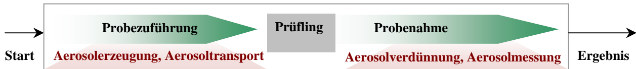
Abb. 1: Aufbau eines Testsystems
