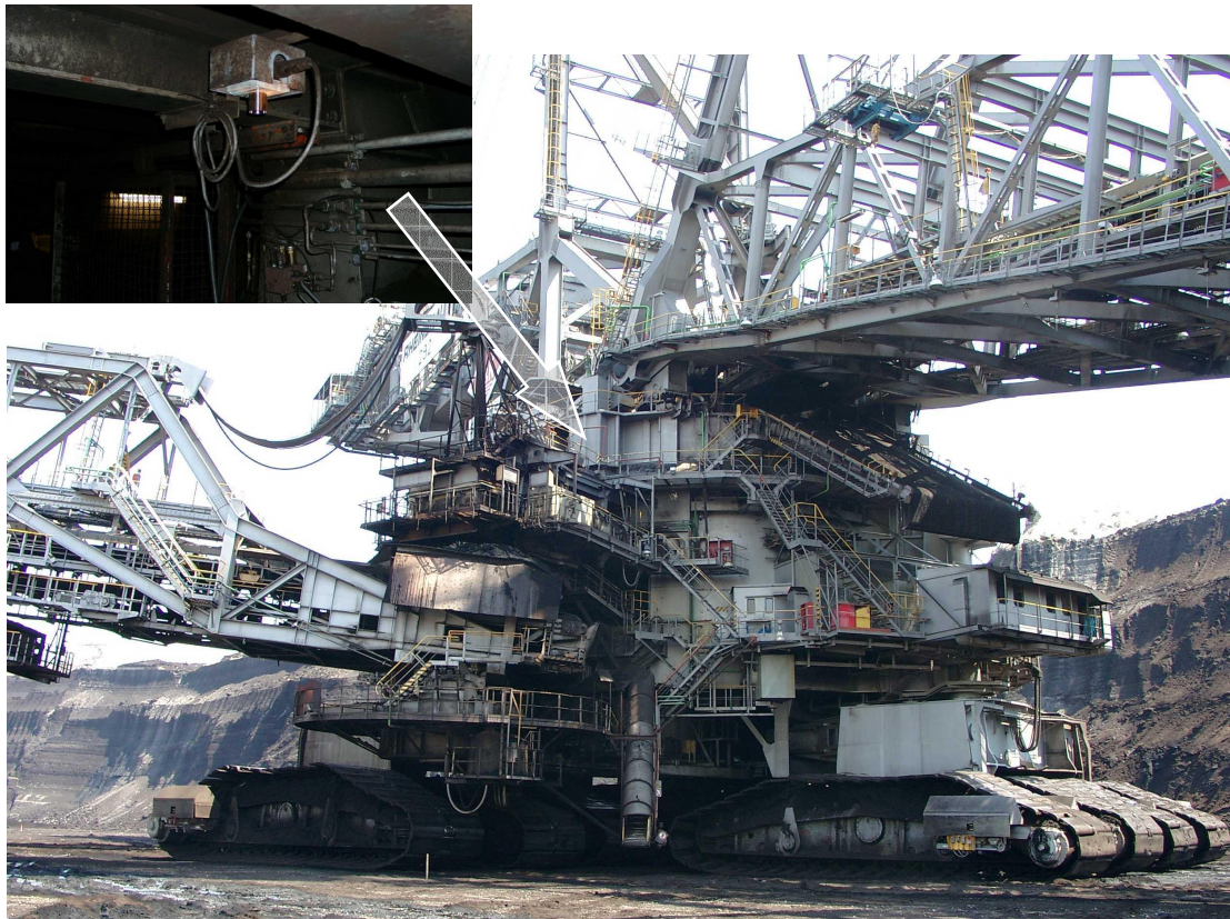
Abbildung 4: Einsatz von ADICOS GSME-Meldern in einem Braunkohlenbagger; Oberes Teilbild: Montageort innerhalb des Turms.
